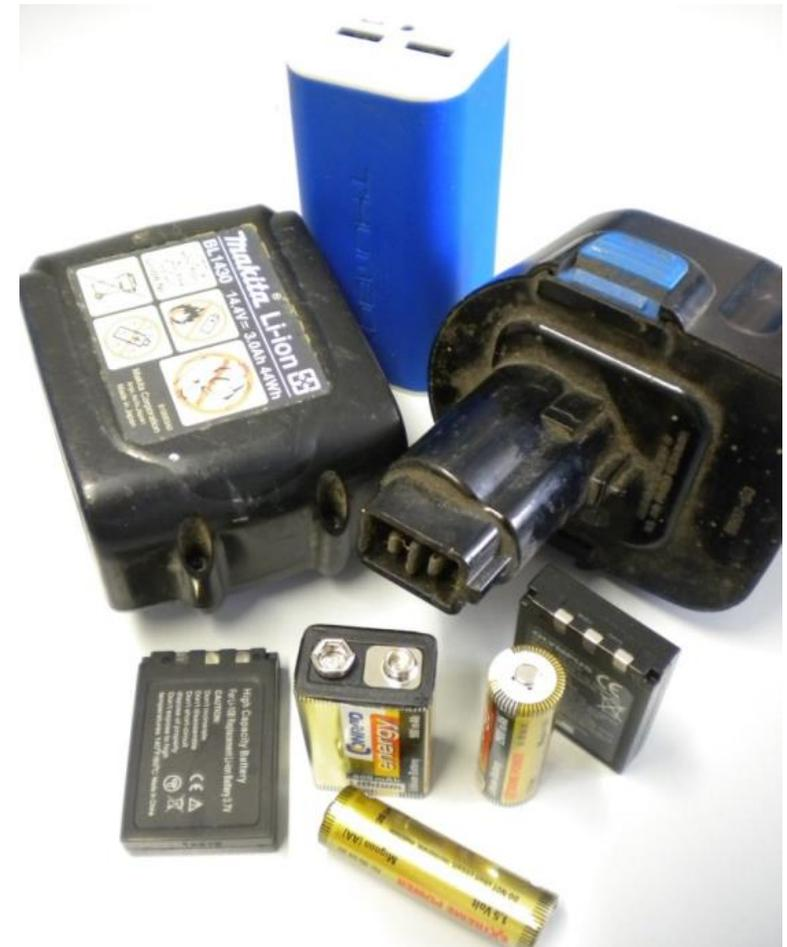
**Li-Batterien sind durch das aufgedruckte „Li“-Zeichen erkennbar.**
