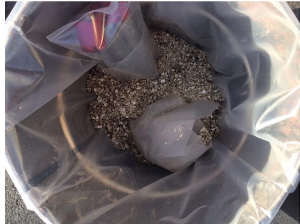
Beschädigter Akku in Kunststoffbeutel in Vermiculite
