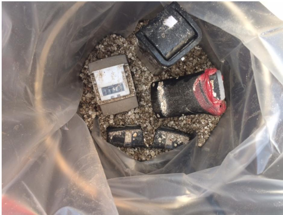
Intakter Akku mit abgeklebten Kontakten
